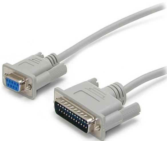
El cable cruzado serial/de módem nulo (3 metros), modelo SCNM925FM, incluye un conector DB9 hembra y un conector DB25 macho, lo cual permite conectar un dispositivo serial de 9 pines a un puerto serial de 25 pines, o bien transferir archivos de PC a PC, a través de una conexión serial.
