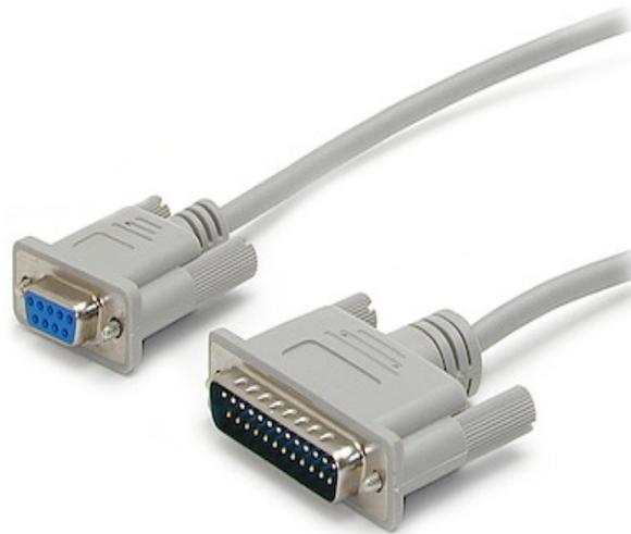
Le câble null modem série SCNM925FM de 3 m à fils croisés comporte un connecteur femelle DB9 et un connecteur mâle DB25 vous permettant de brancher un périphérique série à 9 broches à un port série à 25 broches ou de transférer des fichiers entre des PC par connexion série.
