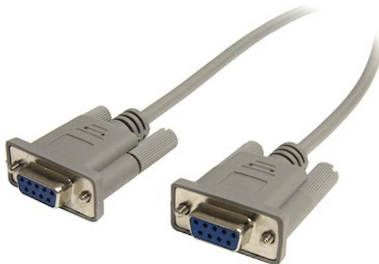
Este cable cruzado serie/de módem nulo de 7,6m incluye dos conectores DB9 hembra, lo cual permite conectar un dispositivo serie de 9 pines a un puerto serie, o transferir ficheros de ordenador a ordenador, a través de una conexión serie.
