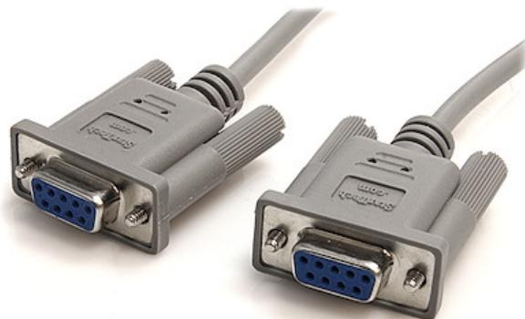
El Cable Cruzado o de Módem Nulo de 10 pies, SCNM9FF dispone de dos conectores hembra DB9, permitiendo conectar una impresora serial a un puerto serie de 9 pines, o transferir archivos de una PC a otra a través de una conexión de puerto serie.
