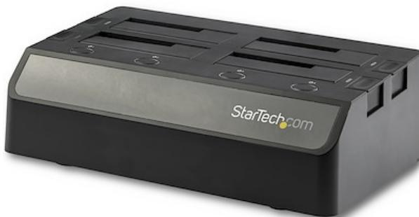
Esta estación de acoplamiento para discos duros SATA de 4 bahías le permite acceder a un máximo de cuatro unidades de estado sólido o discos duros simultáneamente a través de USB (10Gbps), e intercambiar unidades en caliente con facilidad. Ideal para los profesionales de la informática, la estación de acoplamiento ofrece una gran capacidad de datos y rápidas transferencias de archivos, ayudándole a gestionar su flujo de trabajo de forma más eficiente.
