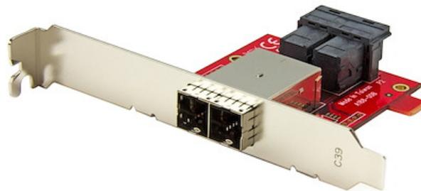
Questo adattatore Mini-SAS consente di convertire due porte SFF-8643 interne di una scheda controller in due porte SFF-8644 esterne. In tal modo è possibile collegare le unità SAS o SATA esterne di vari dispositivi, ad esempio le unità DAS (Direct Attached Storage), a una scheda backplane interna o a un controller SAS per ottenere altro spazio di archiviazione.
