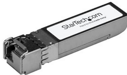
Il SFP-10G-BX60D-I-ST è un ricetrasmittitore SFP+ a valle in fibra compatibile con Cisco SFP-10G-BX60D-I associabile con SFP-10G-BX60U-I-ST di StarTech.com. Sono progettati, programmati e testati per funzionare con switch e router compatibili MSA 10GBASE-BX. Il modulo ricetrasmittitore SFP+ supporta una distanza massima di fino a 60 km e offre una connettività affidabile 10 GbE usando cavi in fibra.
