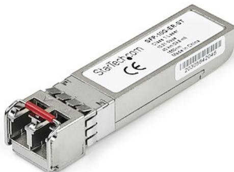
Il SFP-10G-ER-ST è un modulo ricetrasmettitore SFP+ in fibra compatibile con Cisco SFP-10G-ER progettato, programmato e testato per funzionare con switch e router prodotti da Cisco®. Offre una connettività affidabile 10 GbE su cavo in fibra per le reti compatibili con 10GBASE-ER a una distanza massima di 40 km.
