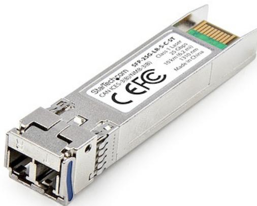
Ce transcepteur optique en fibre est l'équivalent direct du Cisco® SFP-25G-LR-S pour une connectivité de 25 Gbit/s jusqu'à 10 km (6,2 mi) sur un câble en fibre monomode (SMF) terminé par LC. Le module optique a été programmé et testé pour une intégration transparente avec les commutateurs et routeurs Cisco® afin d'assurer la compatibilité et la fiabilité.
