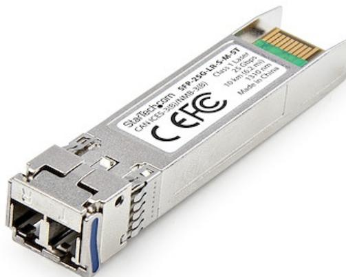
MSA-kompatibler Glasfaser-Transceiver mit 25Gbps Konnektivität bis zu 10km (6,2mi) über LC-terminierte Single Mode Fiber (SMF) Kabel. Das optische Modul wurde für die nahtlose Integration in MSA-kompatible Switches und Router programmiert und getestet, um Kompatibilität und Zuverlässigkeit zu gewährleisten.
