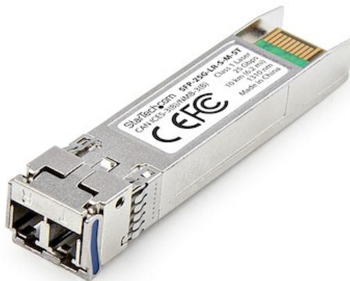
Transceptor de fibra óptica compatible con MSA con una conectividad de 25 Gbps de hasta 10 km a través de cable de fibra monomodo (SMF) con terminación LC. El módulo óptico ha sido programado y probado para una integración perfecta con conmutadores y enrutadores compatibles con MSA para garantizar la compatibilidad y la fiabilidad.
