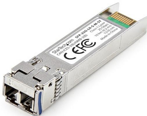
Transceiver optique en fibre conforme à la norme MSA offrant une connectivité de 25 Gbps jusqu'à 10 km (6,2 mi) via un câble à fibre monomode (SMF) avec connecteur LC. Le module optique a été programmé et testé pour une intégration transparente avec des commutateurs et routeurs compatibles MSA afin d'assurer la compatibilité et la fiabilité.
