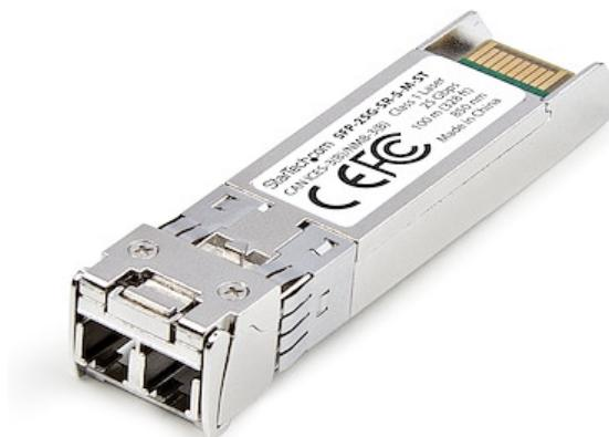
Transceptor de fibra óptica compatible con MSA con conectividad de 25 Gbps y hasta 100 m (328 pies) a través de cable de fibra multimodo (MMF) con terminación LC. El módulo óptico ha sido programado y probado para su perfecta integración con conmutadores y enruteadores compatibles con MSA para garantizar su compatibilidad y fiabilidad.
