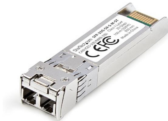
Transcepteur optique en fibre conforme à la norme MSA avec une connectivité de 25 Gbps jusqu'à 100 m (328 pieds) via un câble à fibre multimode (MMF) avec connecteur LC. Le module optique a été programmé et testé pour une intégration transparente avec des commutateurs et routeurs compatibles MSA afin d'assurer la compatibilité et la fiabilité.
