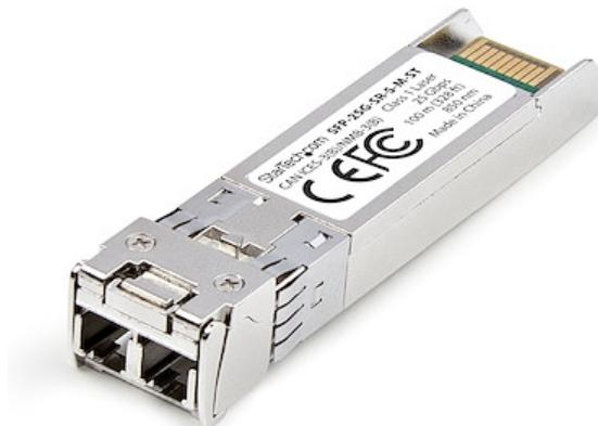
Ricetrasmettitore in fibra ottica conforme a MSA con connettività a 25 Gbps e fino a 100 m su cavo in fibra multimodale (MMF) con terminazione LC. Il modulo ottico è stato programmato e testato per una perfetta integrazione con switch e router compatibili MSA, per garantire compatibilità e affidabilità.
