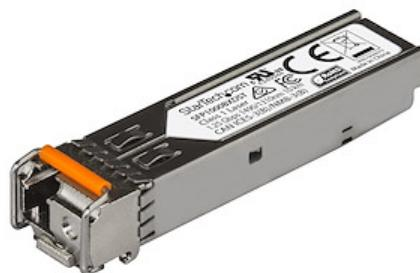
El modelo SFP1000BXDST es un transceptor SFP descendente por fibra óptica compatible con MSA, que se puede emparejar con el modelo SFP1000BXUST de StarTech.com. Ha sido diseñado, programado y probado para su funcionamiento con enrutadores y conmutadores 1000BASE-BX compatibles con MSA. El transceptor SFP admite una distancia máxima de hasta 10km y conectividad fiable a 1GbE a través de cableado de fibra.
