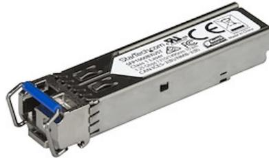
El modelo SFP1000BXUST es un transceptor SFP ascendente por fibra óptica compatible con MSA, que se puede emparejar con el modelo SFP1000BXDST de StarTech.com. Ha sido diseñado, programado y probado para su funcionamiento con enrutadores y conmutadores 1000BASE-BX compatibles con MSA. El transceptor SFP admite una distancia máxima de hasta 10km y conectividad fiable a 1GbE a través de cableado de fibra.
