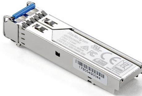
El modelo SFP1000EXST es un transceptor SFP por fibra óptica, conforme a las normas MSA, diseñado, programado y probado para su funcionamiento con enrutadores y conmutadores 1000BASE-EX compatibles con MSA. El módulo transceptor SFP admite una distancia máxima de hasta 40km y conectividad fiable a 1GbE a través de cableado de fibra. **Especificaciones técnicas:**
