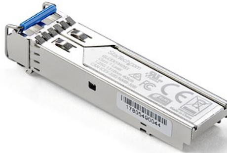
Le SFP1000EXST est un transceiver SFP à fibre optique conforme aux normes MSA qui est conçu, programmé et testé pour fonctionner avec des commutateurs et routeurs 1000BASE-EX conformes aux normes MSA. Le module de transceiver SFP prend en charge une distance maximale de 40 km et fournit une connectivité 1 GbE fiable via un câblage de fibre optique.
