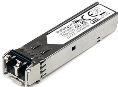
El modelo SFP1000LHST es un transceptor SFP por fibra óptica, conforme a las normas MSA, diseñado, programado y probado para su funcionamiento con enrutadores y conmutadores 1000BASE-LH compatibles con MSA. El módulo transceptor SFP admite una distancia máxima de hasta 40km y conectividad fiable a 1GbE a través de cableado de fibra. **Especificaciones técnicas:**
