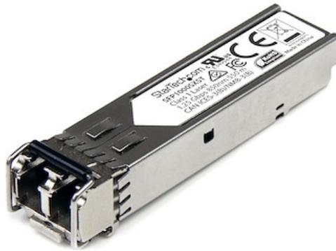
SFP1000SXST è un ricetrasmittitore SFP in fibra conforme a MSA progettato, programmato e testato con switch e router MSA compatibili con 1000BASE-SX. Il modulo ricetrasmittitore SFP supporta una distanza massima fino a 550 m e offre una connettività da 1 GbE affidabile tramite cavo in fibra.
