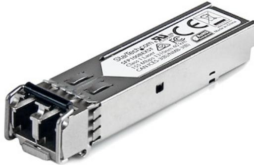
Le SFP100BEXST est un transceiver SFP à fibre optique conforme aux normes MSA qui est conçu, programmé et testé pour fonctionner avec des commutateurs et routeurs 100BASE-EX conformes aux normes MSA. Le module de transceiver SFP prend en charge une distance maximale de 40 km et fournit une connectivité Ethernet 100 Mb fiable via un câblage de fibre optique. <b>Spécifications techniques : </b>
