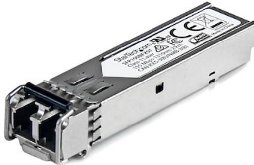
El modelo SFP100BFXST es un transceptor SFP por fibra óptica, conforme a las normas MSA, diseñado, programado y probado para su funcionamiento con enrutadores y conmutadores 100BASE-FX compatibles con MSA. El módulo transceptor SFP admite una distancia máxima de hasta 2km y conectividad confiable Ethernet a 100Mb a través de cableado de fibra.
