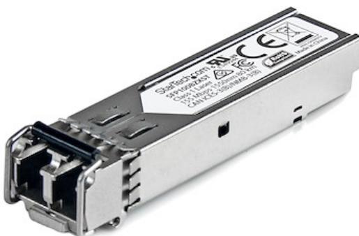
El modelo SFP100BZXST es un transceptor SFP por fibra óptica, conforme a las normas MSA, diseñado, programado y probado para su funcionamiento con enrutadores y conmutadores 100BASE-ZX compatibles con MSA. El módulo transceptor SFP admite una distancia máxima de hasta 80km y conectividad fiable Ethernet a 100Mb a través de cableado de fibra. <b>Especificaciones técnicas: </b>
