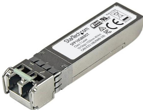
El modelo SFP10GBERST es un transceptor SFP por fibra óptica, conforme a las normas MSA, diseñado, programado y probado para su funcionamiento con enrutadores y conmutadores 10GBASE-ER compatibles con MSA. El transceptor SFP+ admite una distancia máxima de hasta 40km y conectividad fiable a 10GbE a través de cableado de fibra. <b>Especificaciones técnicas: </b>
