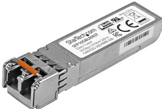
El modelo SFP10GBLRMST es un transceptor SFP por fibra óptica, conforme a las normas MSA, diseñado, programado y probado para su funcionamiento con enrutadores y conmutadores 10GBASE-LRM compatibles con MSA. El transceptor SFP+ admite una distancia máxima de hasta 220m y conectividad fiable a 10GbE a través de cableado de fibra. **Especificaciones técnicas:**
