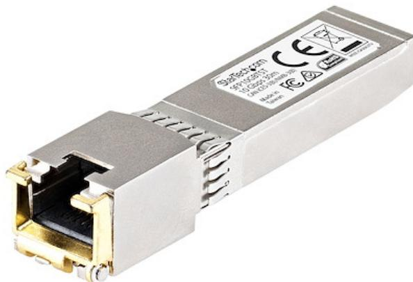
El modelo SFP10GBT-CST es un módulo transceptor por cobre, diseñado, programado y probado para su funcionamiento con enruteadores y conmutadores de la marca Cisco®. Ofrece conectividad fiable a 10GbE a través de cable de cobre para redes compatibles con 10GBASE-T, con una distancia máxima de hasta 30m.
