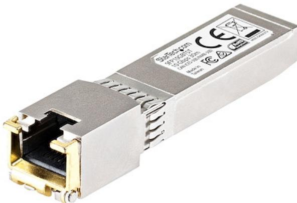
Il prodotto SFP10GBTCS è un modulo ricetrasmettitore in rame compatibile con Cisco, progettato, programmato e testato per operare con switch e router a marchio Cisco®. Offre un'affidabile connettività da 10 GbE tramite cablaggi in rame per le reti compatibili con 10BASE-T, a una distanza massima di 30 m.
