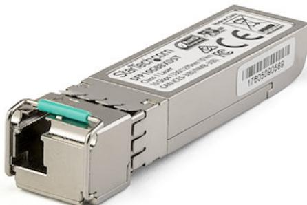
Le SFP10GBX10DS est un transceiver SFP+ fibre optique en aval compatible Dell EMC SFP-10G-BX10-D qui fonctionne avec SFP-10G-BX10-U de StarTech.com. Ils sont conçus, programmés et testés pour fonctionner avec des commutateurs et des routeurs compatibles avec les normes MSA 10GBASE-BX10. Le module de transceiver SFP+ fonctionne jusqu'à une distance de 10 km et vous assure une connectivité de 10 GbE par câblage optique.
