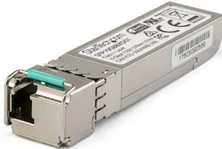
Der SFP10GBX10US ist ein MSA-konformer Upstream Glasfaser SFP+-Transceiver, der mit SFP-10G-BX10-D von StarTech.com verbunden werden kann. Er wurde für den Einsatz mit 10GBASE-BX10-kompatiblen MSA-Switches und -Routern entwickelt. Das SFP+-Transceiver-Modul unterstützt eine maximale Entfernung von bis zu 10 km und sorgt für zuverlässige 10 GbE-Konnektivität via Glasfaser-Verkabelung.
