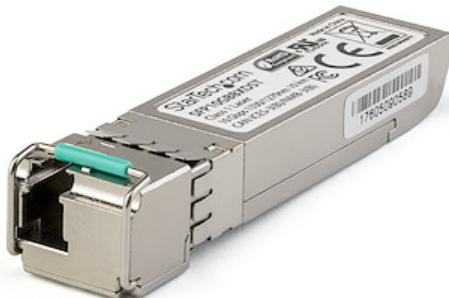
El modelo SFP10GBX10US es un transceptor SFP+ upstream por fibra óptica compatible con el modelo SFP-10G-BX10-U de Dell EMC, que se puede emparejar con SFP-10G-BX10-D de StarTech.com. Ha sido diseñado, programado y probado para su funcionamiento con routers y switches MSA compatibles con 10GBASE-BX10. El módulo transceptor SFP+ admite una distancia máxima de hasta 10 km y conectividad fiable a 10 GbE a través de cableado de fibra óptica.
