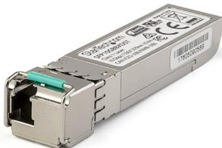
Il SFP10GBX10US è un ricetrasmettitore SFP+ a monte in fibra compatibile con Dell EMC SFP-10G-BX10-U associabile con SFP-10G-BX10-D di StarTech.com. Sono progettati, programmati e testati per funzionare con switch e router compatibili MSA 10GBASE-BX10. Il modulo ricetrasmettitore SFP+ supporta una distanza massima di fino a 10 km e offre una connettività affidabile 10 GbE usando cavi in fibra.
