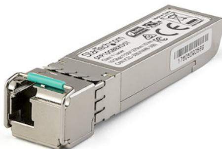
Il SFP10GBX40US è un ricetrasmettitore SFP+ a monte in fibra compatibile con Dell EMC SFP-10G-BX40-U associabile con SFP-10G-BX40-D di StarTech.com. Sono progettati, programmati e testati per funzionare con switch e router compatibili MSA 10GBASE-BX40. Il modulo ricetrasmettitore SFP+ supporta una distanza massima di fino a 40 km e offre una connettività affidabile 10 GbE usando cavi in fibra.
