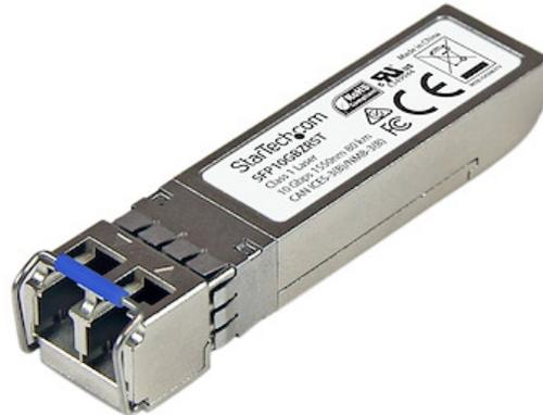
SFP10GBZRST è un ricetrasmittitore SFP in fibra conforme a MSA progettato, programmato e testato con switch e router MSA compatibili con 10GBASE-ZR. Il modulo ricetrasmittitore SFP+ supporta una distanza fino a 80 km e offre una connettività da 10 GbE affidabile tramite cavo in fibra.
