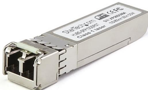
El modelo SFP10GEREMST es un módulo transceptor SFP+ por fibra óptica compatible con el modelo SFP-10G-ER de Dell EMC diseñado, programado y probado para su funcionamiento con routers y switches de la marca Dell EMC™. Ofrece conectividad fiable a 10 GbE, a través de cable de fibra óptica, para redes compatibles con 10GBASE-ER, a una distancia máxima de hasta 40 km.
