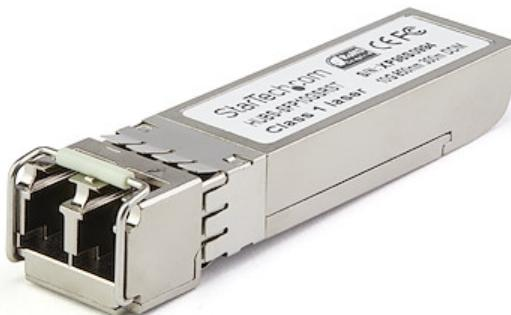
El modelo SFP10GEREMST es un módulo transceptor SFP+ por fibra óptica compatible con el modelo SFP-10G-ER de Dell EMC diseñado, programado y probado para su funcionamiento con routers y switches de la marca Dell EMC™. Ofrece conectividad confiable a 10 GbE, a través de cable de fibra óptica, para redes compatibles con 10GBASE-ER, a una distancia máxima de hasta 40 km.
