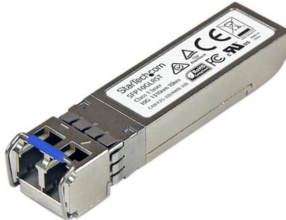
Le modèle SFP10GLRST est un module de transceiver à fibre optique compatible avec Cisco SFP-10G-LR, qui a été conçu, programmé et testé pour fonctionner avec les commutateurs et routeurs de la marque Cisco™. Il fournit une connectivité 10 GbE fiable sur câble à fibre optique pour les réseaux conformes aux spécifications 10GBASE-LR, avec une distance maximale de 10 km.
