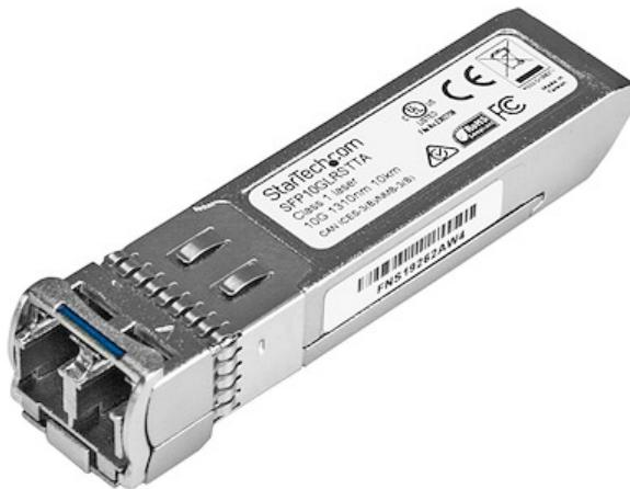
Il prodotto SFP10GLRST è un modulo ricetrasmettitore per fibra compatibile con Cisco SFP-10G-LR e conforme al Trade Agreements Act (TAA), progettato, programmato e testato per operare con switch e router a marchio Cisco™. Offre un'affidabile connettività da 10 GbE tramite cavo in fibra per le reti compatibili con 10GBASE-LR, con distanza massima di 10 km.
