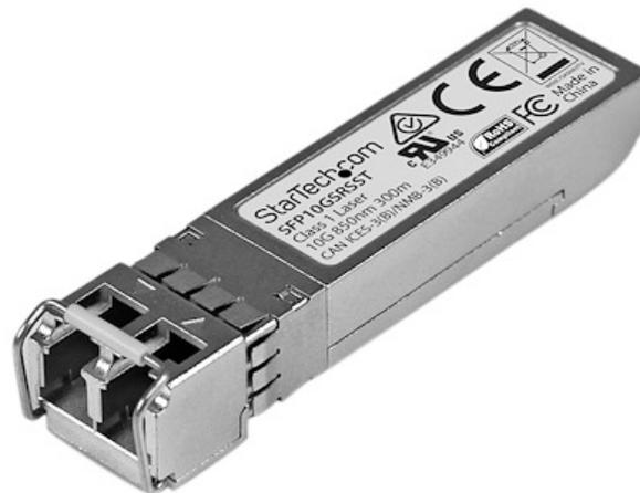
El modelo SFP10GSRSSST es un módulo transceptor por fibra óptica, compatible con Cisco SFP-10G-SR-S, diseñado, programado y probado para su funcionamiento con enrutadores y conmutadores de la marca Cisco®. Ofrece conectividad 10GbE fiable a través de cable de fibra óptica para redes compatibles con 10GBASE-SR, con una distancia máxima de hasta 300m.
