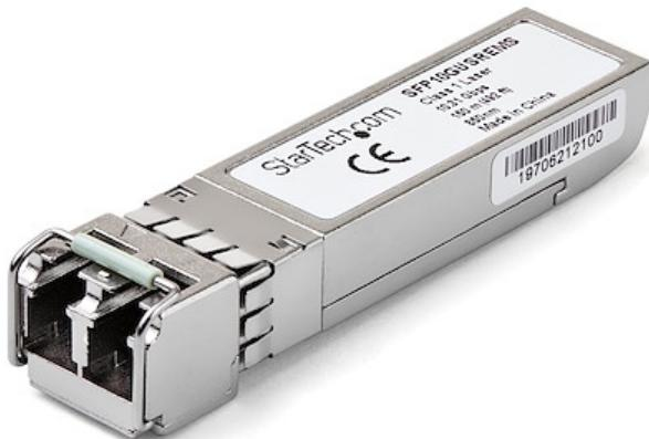
Il SFP10GUSREMS è un modulo ricetrasmettitore SFP+ in fibra compatibile con Dell EMC SFP-10G-USR progettato, programmato e testato per funzionare con switch e router prodotti da Dell EMC™. Offre una connettività affidabile 10 GbE su cavo in fibra per le reti compatibili con 10GBASE-SR a una distanza massima di 150 m.
