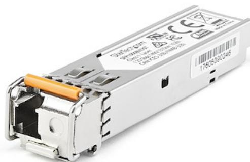
Il SFP1GBX10UES è un ricetrasmettitore SFP a monte in fibra compatibile con Dell EMC SFP-1G-BX10-U associabile con SFP1GBX10DES di StarTech.com. Sono progettati, programmati e testati per funzionare con switch e router compatibili MSA 1000BASE-BX10. Il modulo ricetrasmettitore SFP+ supporta una distanza massima di fino a 10 km e offre una connettività affidabile 1 GbE usando cavi in fibra.
