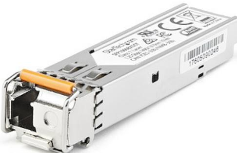
Der SFP1GBX40DES ist ein MSA-konformer Downstream Glasfaser SFP-Transceiver, der mit SFP1GBX40UES von StarTech.com verbunden werden kann. Er wurde für den Einsatz mit 1000BASE-BX40-kompatiblen MSA-Switches und -Routern entwickelt. Das SFP+-Transceiver-Modul unterstützt eine maximale Entfernung von bis zu 40 km und sorgt für zuverlässige 1 GbE-Konnektivität via Glasfaser-Verkabelung.
