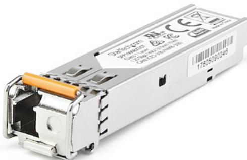
El modelo SFP1GBX40DES es un transceptor SFP downstream por fibra óptica compatible con el modelo SFP-1G-BX40-D de Dell EMC, que se puede emparejar con SFP1GBX40UES de StarTech.com. Ha sido diseñado, programado y probado para su funcionamiento con routers y switches MSA compatibles con 1000BASE-BX40. El módulo transceptor SFP+ admite una distancia máxima de hasta 40 km y conectividad fiable a 1 GbE a través de cableado de fibra óptica.
