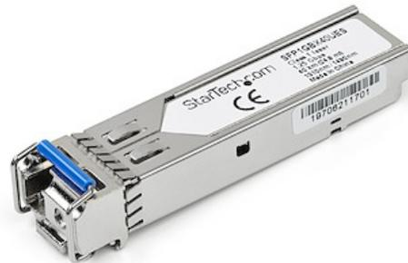
Il SFP1GBX40UES è un ricetrasmittitore SFP a monte in fibra compatibile con Dell EMC SFP-1G-BX40-U associabile con SFP1GBX40DES di StarTech.com. Sono progettati, programmati e testati per funzionare con switch e router compatibili MSA 1000BASE-BX40. Il modulo ricetrasmittitore SFP+ supporta una distanza massima di fino a 40 km e offre una connettività affidabile 1 GbE usando cavi in fibra.
