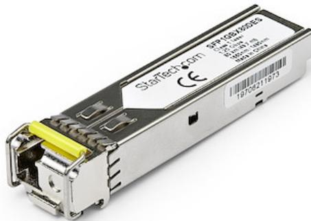
Il SFP1GBX80DES è un ricetrasmittitore SFP a valle in fibra compatibile con Dell EMC SFP-1G-BX80-D associabile con SFP1GBX80UES di StarTech.com. Sono progettati, programmati e testati per funzionare con switch e router compatibili MSA 1000BASE-BX80. Il modulo ricetrasmittitore SFP+ supporta una distanza massima di fino a 80 km e offre una connettività affidabile 1 GbE usando cavi in fibra.
