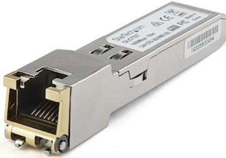
El modelo SFP1GEFEETST es un módulo transceptor SFP por cobre compatible con el modelo SFP-1GE-FE-E-T de Juniper diseñado, programado y probado para su funcionamiento con routers y switches de la marca Juniper®. Ofrece conectividad confiable a 1 GbE, a través de cable de cobre, para redes compatibles con 10/100/1000BASE-TX, a una distancia máxima de hasta 100 m.
