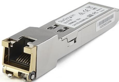
El modelo SFP1GETST es un módulo transceptor SFP por cobre compatible con el modelo SFP-1GE-T de Juniper diseñado, programado y probado para su funcionamiento con routers y switches de la marca Juniper®. Ofrece conectividad fiable a 1 GbE, a través de cable de cobre, para redes compatibles con 1000BASE-T , a una distancia máxima de hasta 100 m.
