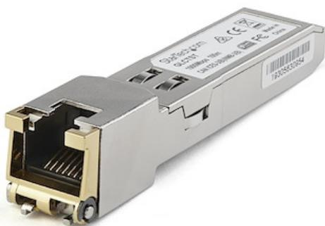
Il SFP1GETST è un modulo ricetrasmettitore SFP in rame compatibile con Juniper SFP-1GE-T progettato, programmato e testato per funzionare con switch e router prodotti da Juniper®. Offre una connettività affidabile 1 GbE su cavo in rame per le reti compatibili con 1000BASE-T a una distanza massima di 100 m.
