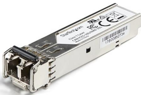
El modelo SFP1GSXEMCST es un módulo transceptor SFP por fibra óptica compatible con el modelo SFP-1G-SX de Dell EMC diseñado, programado y probado para su funcionamiento con routers y switches de la marca Dell EMC™. Ofrece conectividad fiable a 1 GbE, a través de cable de fibra óptica, para redes compatibles con 1000BASE-SX, a una distancia máxima de hasta 550 m.
