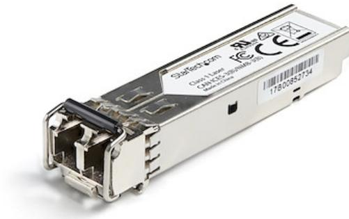
El modelo SFP1GZXEMCST es un módulo transceptor SFP por fibra óptica compatible con el modelo SFP-1G-ZC de Dell EMC diseñado, programado y probado para su funcionamiento con routers y switches de la marca Dell EMC™. Ofrece conectividad fiable a 1 GbE, a través de cable de fibra óptica, para redes compatibles con 1000BASE-ZX, a una distancia máxima de hasta 80 km.
